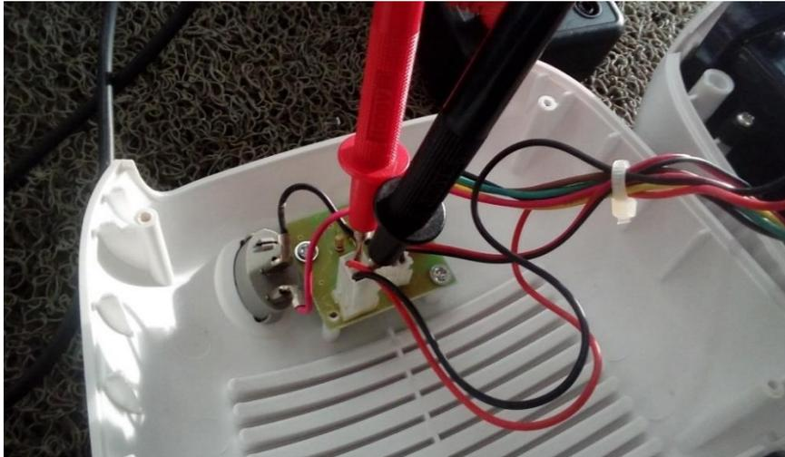
Acionar manualmente micro switch simulando presença do reservatório, fazer leitura de tensão.
